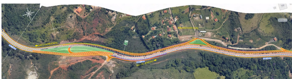
Figura 31: Solução proposta para o km 587+500 ao km 588+500 | Fonte: Elaborado por AMIG/AMALPA
