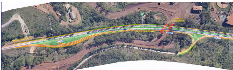
Figura 34: Solução proposta para o trecho entre os kms 597+500 e 598+500 | Fonte: Elaborado por AMIG/AMALPA
