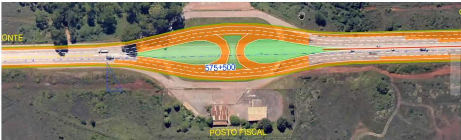
Figura 29: Solução proposta para o km 575+500 | Fonte: Elaborado por AMIG/AMALPA
