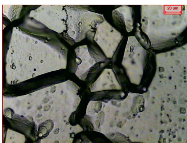
Figura 1 - Microestrutura do aço P430 500X; aquecido a 900°C – 10 min.; resfriado ao ar; Prática W.
